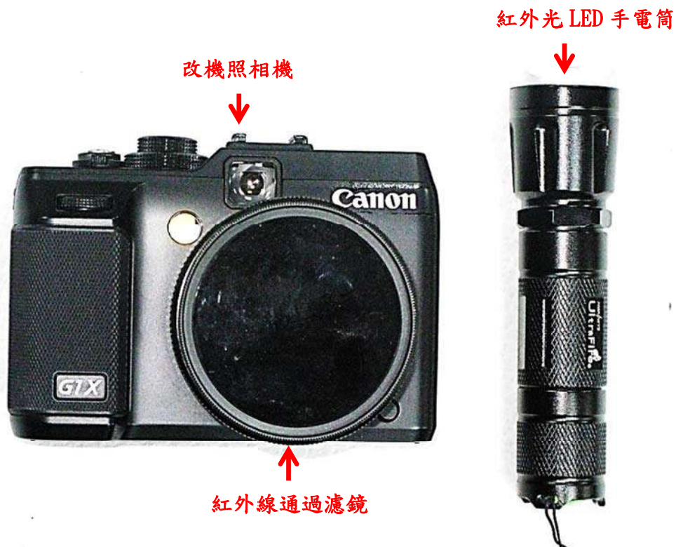
【圖三十七】紅外光 LED 手電筒 + 改機照相機(含紅外線通過濾鏡)
