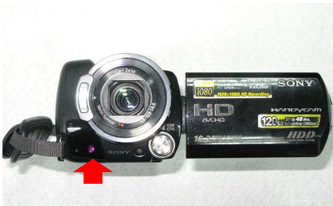
【圖三十六】SONY HDR-SR12 攝影機以 LED 小燈泡為發光源
