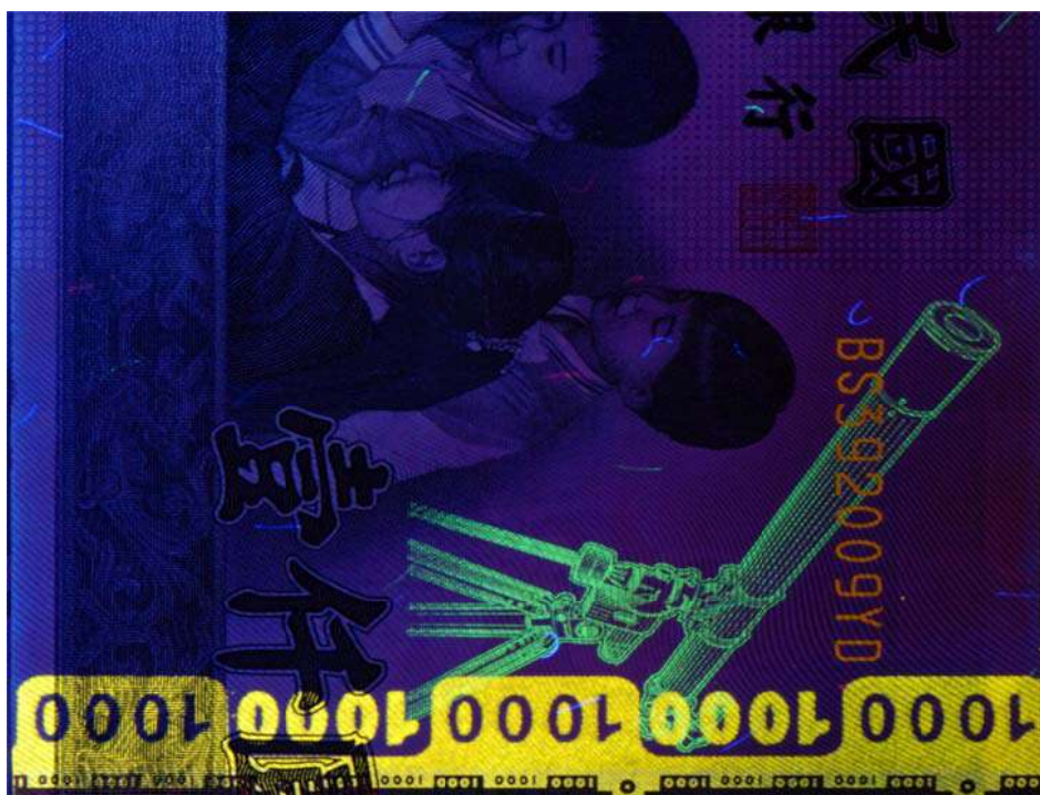
【圖五】以紫外光檢視鈔票上防偽標示
