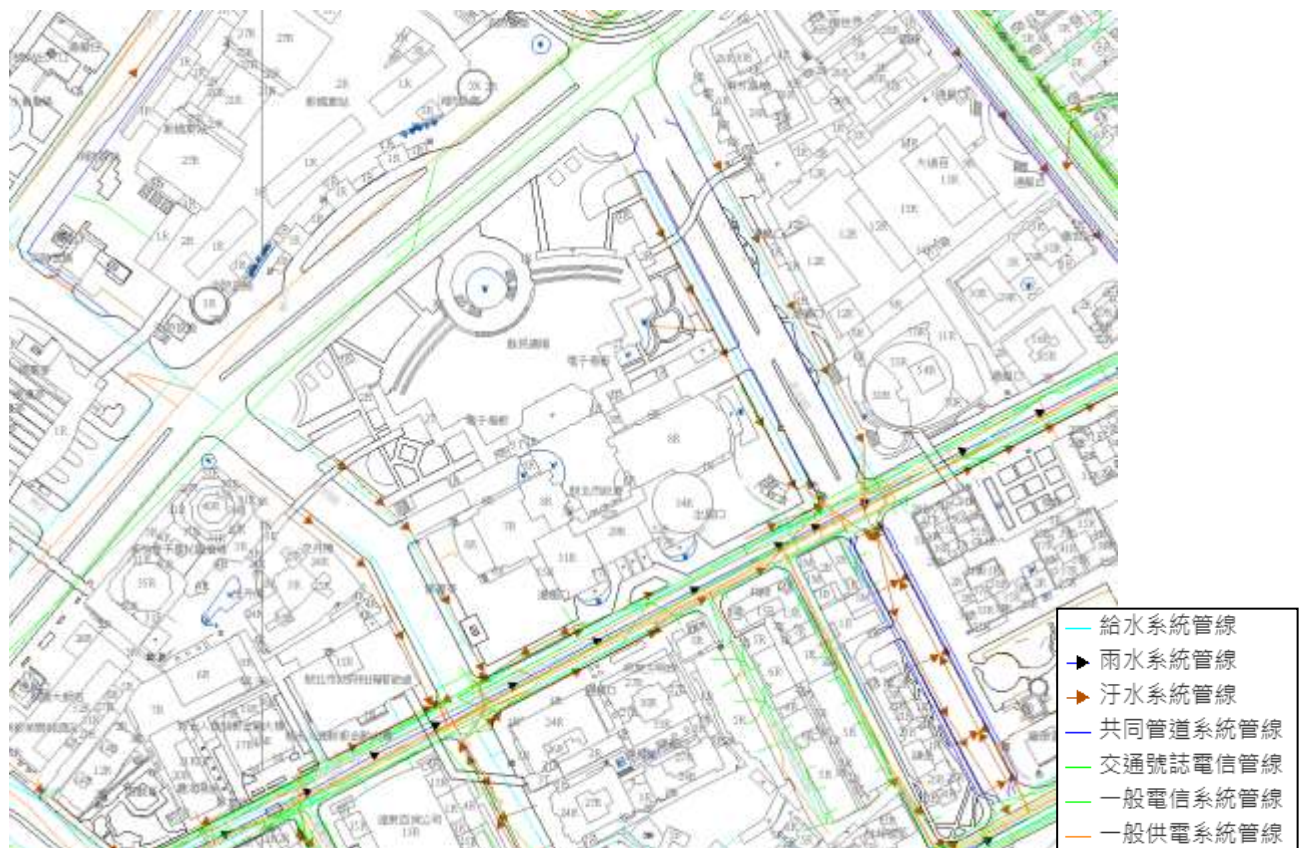
圖十二、數值地形圖套疊各類管線圖
