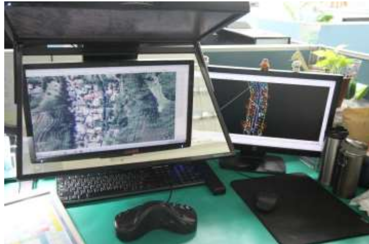
圖十、數值航測影像工作站
