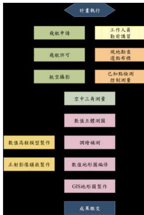
圖三、航測地形圖作業步驟
