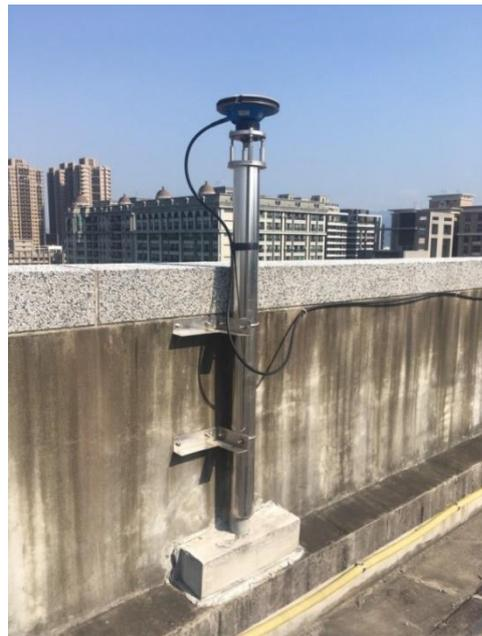
圖 4 Topcon GRS-1 衛星接收儀、圖 5 用於架設衛星儀器之固定樁
