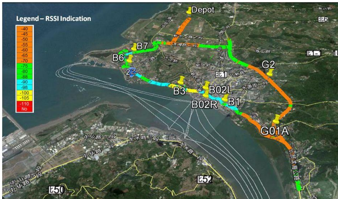
圖 4 基地台所提供無線電手機複合無線電訊號量測圖[4]
