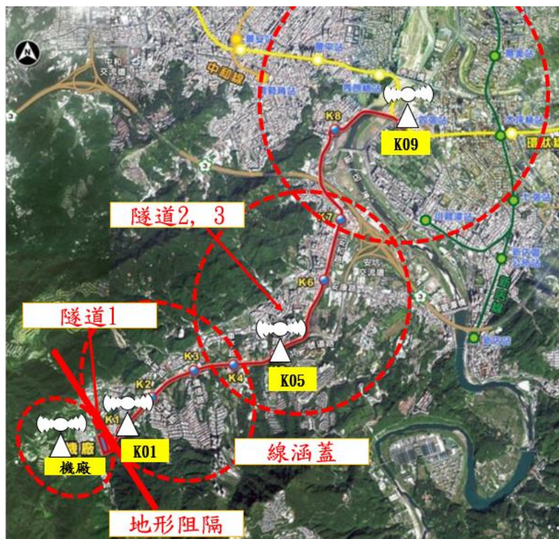
圖 7-2 安坑輕軌無線電基地台涵蓋範圍示意圖[7]
