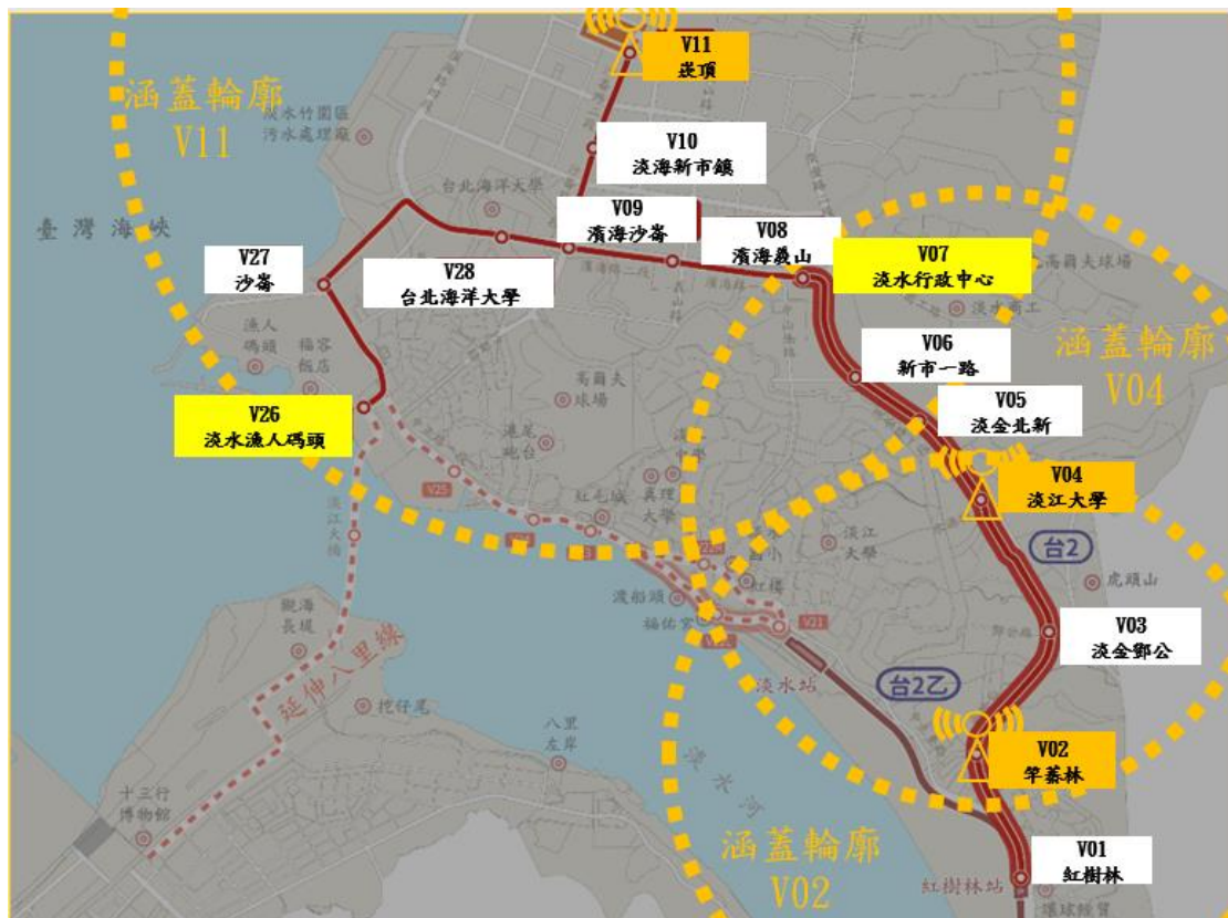
圖 5 淡海輕軌初始設計無線電中繼台涵蓋總圖[1]
