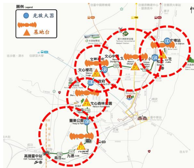
圖 7-3 台中線捷運無線電基地台涵蓋範圍示意圖[9]
