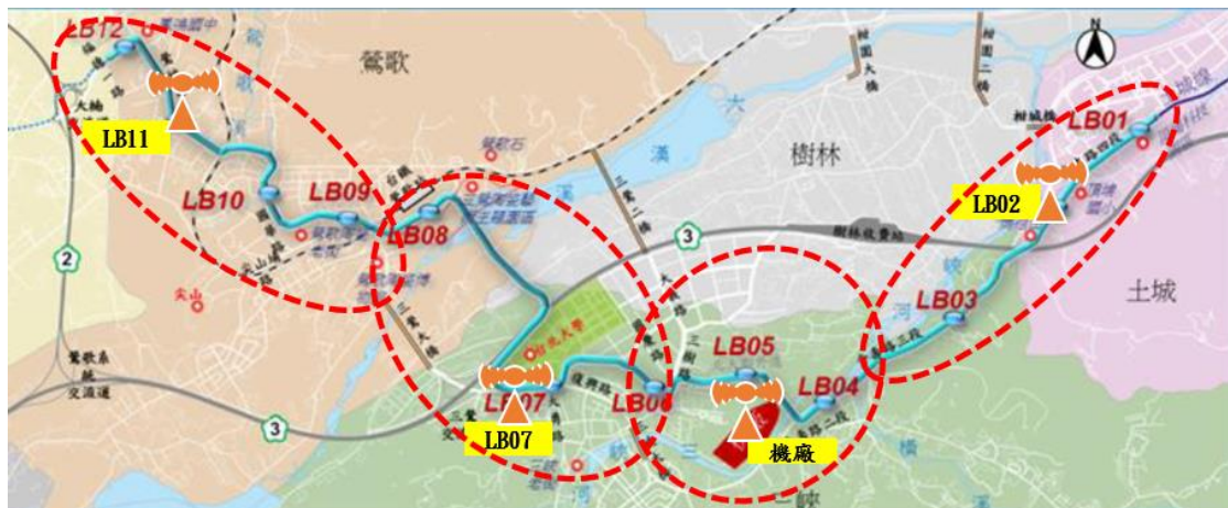
圖 7-1 三鶯線捷運無線電基地台涵蓋範圍示意圖[6]
