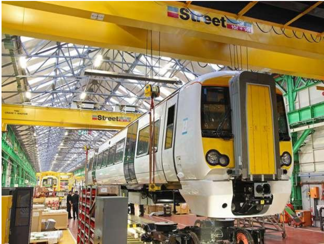
圖 16 架空式起重機吊運車廂
