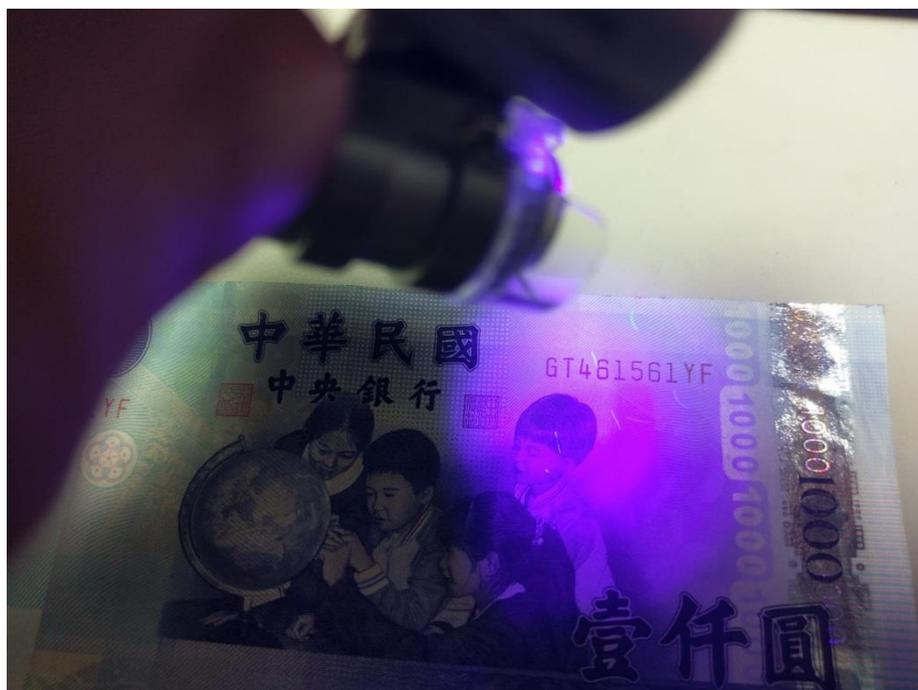
圖九十、60X 可驗鈔微距鏡頭前白光可切換紫光驗鈔
