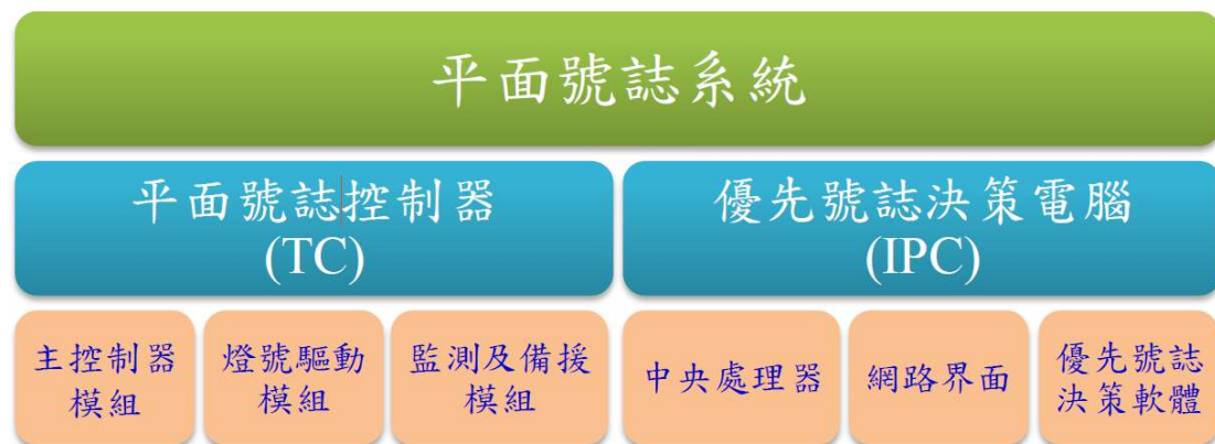
圖 2 平面號誌系統硬體功能區塊圖表
