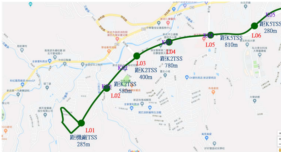
圖 5 安坑輕軌平面號誌路口配置及鄰近車站、TSS 距離示意圖
