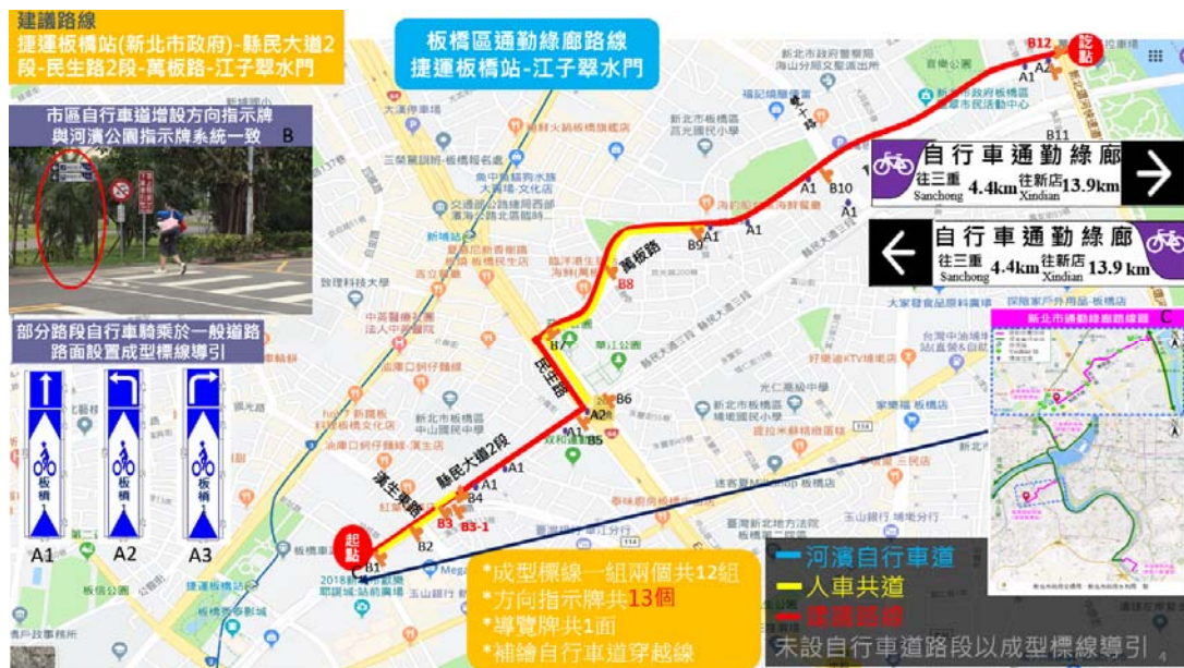
圖 10 板橋區自行車通勤綠廊路線標誌標線規劃圖及導覽牌
